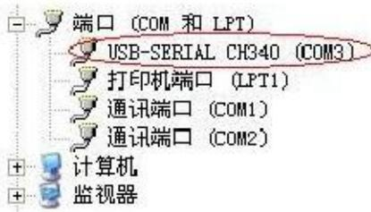
3. 连接 RS232 转 USB 和 RS232 转 485 转换接头, 并通过此接头将电脑与超声波流量计连接, 打开模拟键盘软件, 设置通讯端口参数, 如下:
