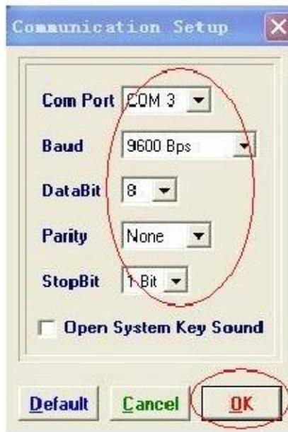
设置完成后即可对流量计进行参数设置.
